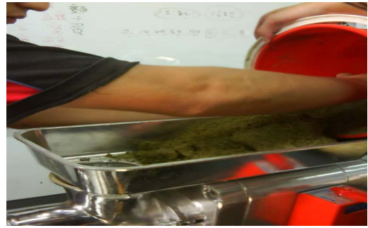
圖十、把攪拌好的水芙蓉塊狀放入粉碎機粉碎。
