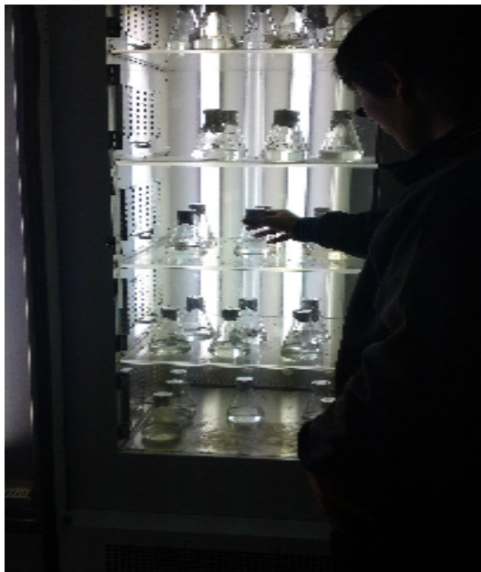
圖 7.將接完藻種的三角瓶放入恆溫培養箱照光培養。
