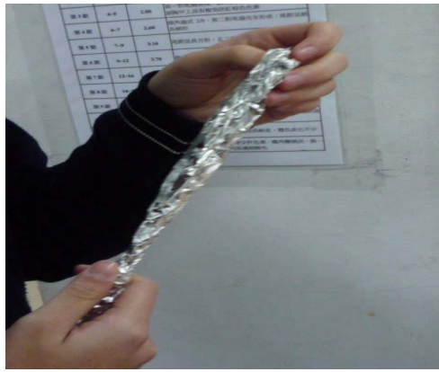
圖 2.在將所有會用到的器具用鋁箔包包起來。
