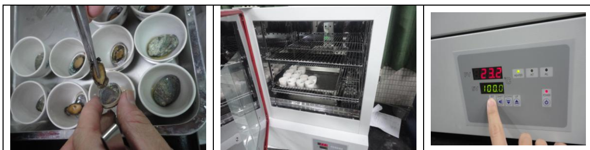
(圖 12) 分別放入坩鍋後，再以 100℃ 的烘箱進行 12 小時乾燥。
