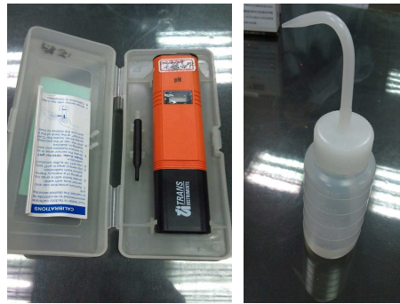
圖 8、酸鹼度(pH)值之測量器具
