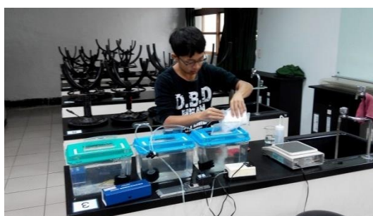
(圖 3) 計算出各鹽度需添加多少淡水及精鹽，以調整至各飼養箱所要求鹽度，然後各放入打氣石，連接風管，開啟打氣機養水 1 週。
