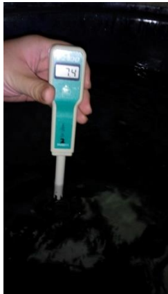
(圖 11) 接著測量 pH 值、水溫、氨。
