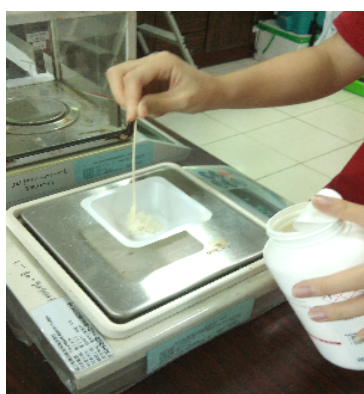
(圖四)秤取 5 碟 1.25 g 及 4 碟 2.5 g 之褐藻膠粉
