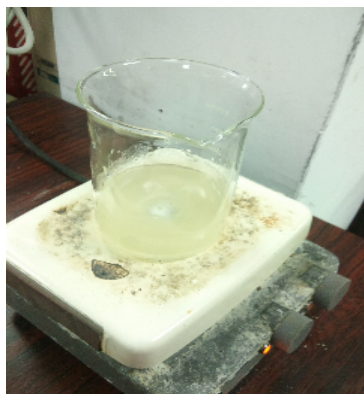
(圖五)分別將褐藻膠粉加入燒杯中並攪拌至融溶狀態
