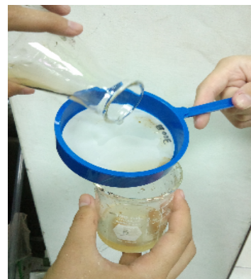
(圖六)將全部淡水海水經濟性微細藻類依此方法用 300 目過濾
