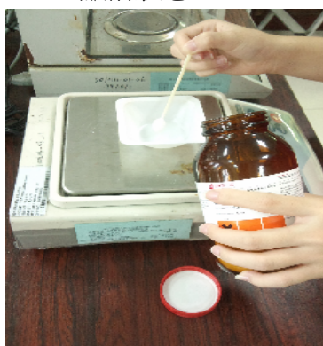
(圖八)秤取 9 碟 1.47g 之氯化鈣粉末，分別將其溶入 100 c.c.之無菌淡水中
