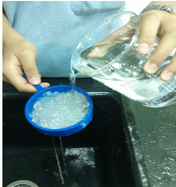
(圖十)待 15 分鐘後，用蒸餾水反覆沖洗，將氯化鈣除去
