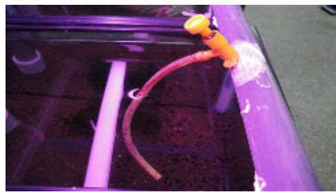
圖 13. 風管剪取適當長度數條再將其相接至每個調氣閥。
