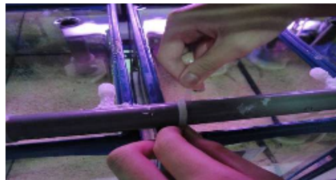
圖 21. 將注水管用束帶固定在魚缸上方
