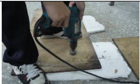
圖 8. 確定位置並劃量魚缸底部的溢流管穿越的孔，再鑽孔洞
