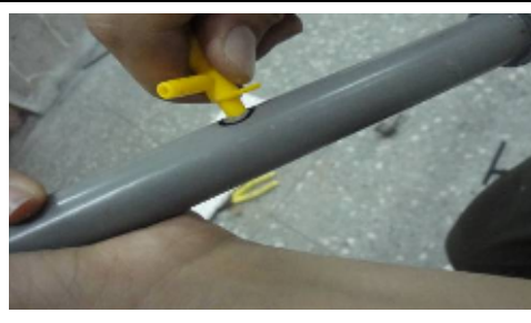
圖 12. 在畫記的位置鑽洞，再將調氣閥插入鑽好的洞並用吸利康固定。
