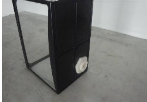
圖 4. 將水管螺絲旋入鑽好的洞。
