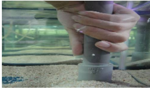
圖 6. 旋入已固定好的水管螺絲，再將直徑為 16mm 的水管取約 20cm 的長度，插入水管螺絲上方的給水止閥。
