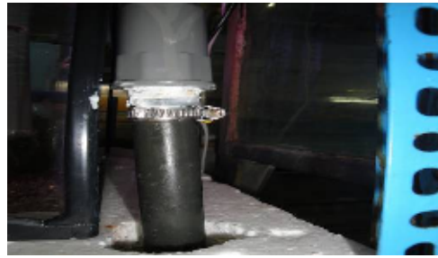
圖 19. 再利用軟管將注水管路連接至桶式過濾器。
