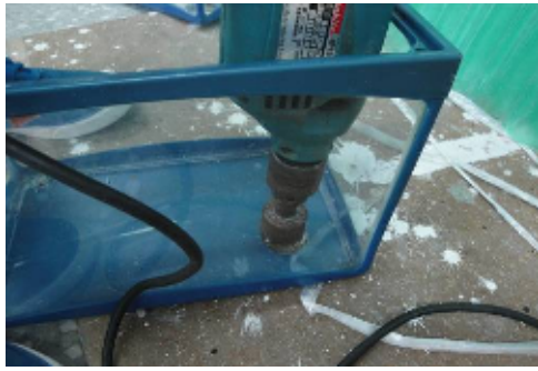
圖 3. 將其八個 1.1 呎的魚缸缸底，分別用電鑽鑽一個直徑 4 公分的洞。
