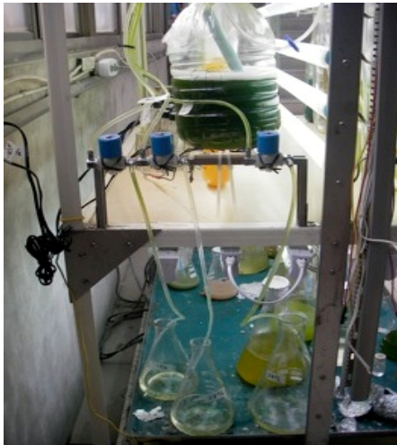
圖 9.裝置好電磁閥並把每條塑膠管依其投餵量放入每個瓶三角瓶中。
