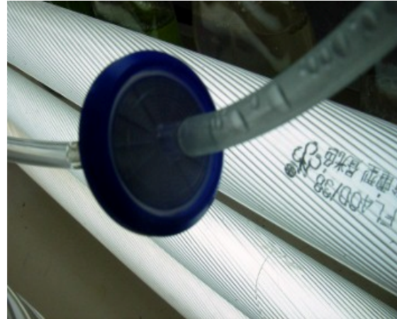
圖 8. 在打氣用的塑膠管上裝一個空氣過濾膜，防止空氣中雜質污染。
