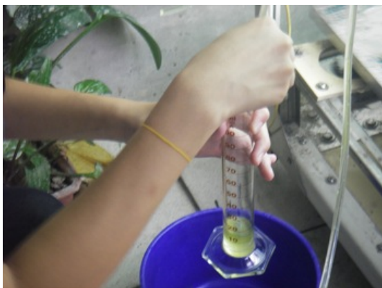
圖 11.並利用微細管的滴流量測試好穩定性，使其保持流量固定。
