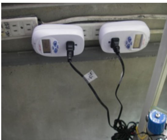
圖 17. 調整好定時器之時間後，並依每個不同投餵次數標以區分。
