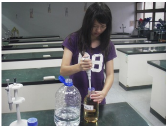
圖 3. 裝入三分滿的海水，並用微量吸管吸取 5 cc 的 walne 營養鹽 I 至塑膠桶內。
