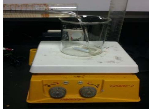
(圖四)取一燒杯裝入沙拉油並放置在加熱攪拌器上，開始攪拌不加熱
