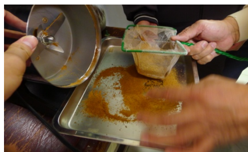
(圖二十一)以不同網目的手操網篩選顆粒大小
