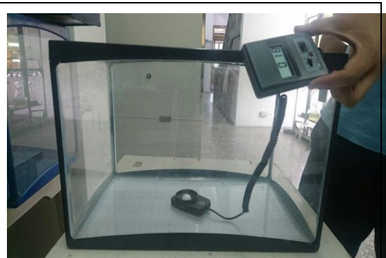
圖 5 把光照度計感應器放置於水族箱正下方。
