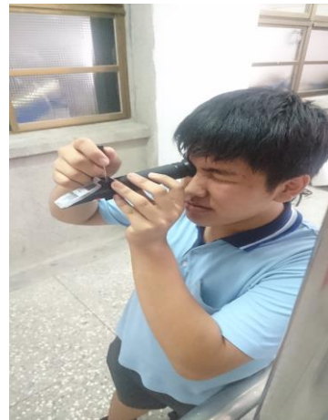
圖 7 使用校正螺絲起子調整至 0%。
