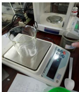
圖 5 將燒杯放置電子天平上歸零
